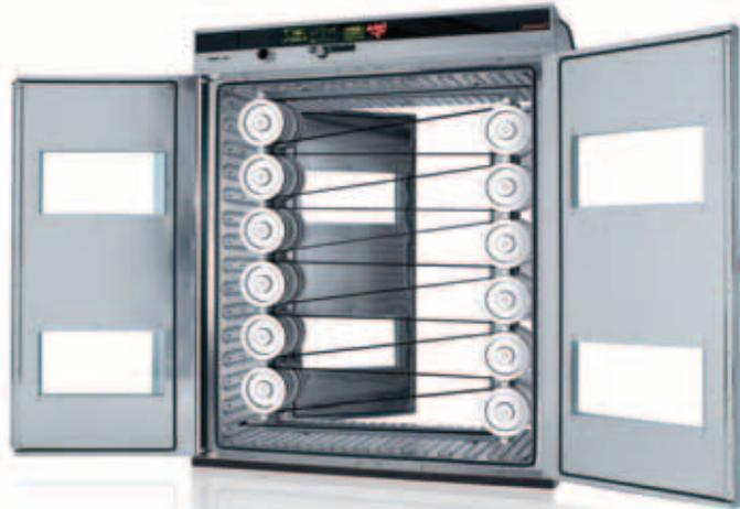
Horno de paso continuo con modo de funcionamiento en línea (franja lateral de carga y descarga)
