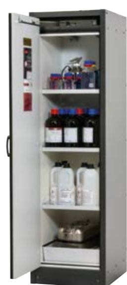
Armoire de sécurité Q-CLASSIC-30 Modèle Q30.195.056 avec porte battante, (Jaune sécurité RAL 1004 ou Gris clair, RAL 7035) équipement intérieur avec 3 étagères, bac de rétention (en acier revêtu d'époxy), plinthe et caillebotis en option Code article 31002-060-30078 (Jaune sécurité) Code article 31002-061-30078 (Gris clair)
