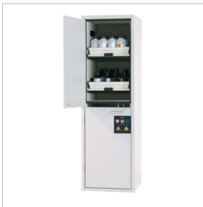
Armoire acides/bases SL-CLASSIC Modèle SL.196.060.MH Gris clair (RAL 7035) avec 4 étagères coulissantes et bacs de rétention en plastique Code article 30612-001-30614
