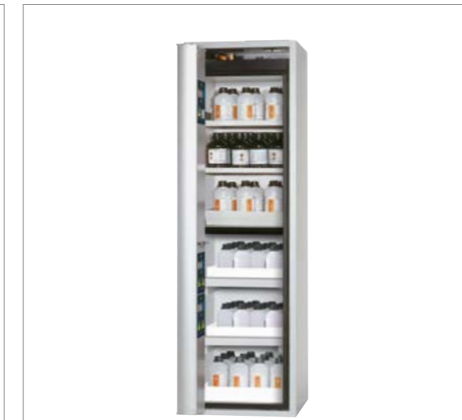
Armoire de sécurité combinée K-CLASSIC-90 Modèle K90.196.060.MH.FDAS Gris clair (RAL 7035), porte pliante avec système de maintien de porte, paroi de séparation horizontale, Partie supérieure : 2 étagères, caillebotis et bac de rétention au sol, Partie inférieure : 2 bacs étagères et bac de rétention sol (mélamine/PE) Code article 30709-001-30354
