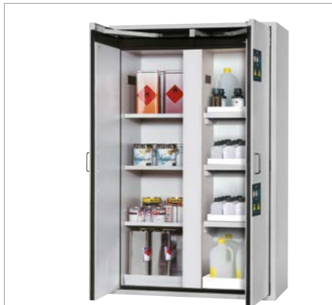
Armoire de sécurité combinée K-CLASSIC-90 Modèle K90.196.120.MV.WDAS Gris clair (RAL 7035), portes battantes système de maintien de porte, paroi de séparation, Côté gauche : 3 étagères, caillebotis et bac de rétention au sol (en acier, revêtement époxy), Côté droit : 3 étagères (en bois, mélaminé) avec bac (PE), au sol bac de rétention (PE) Code article 30348-001-30349
