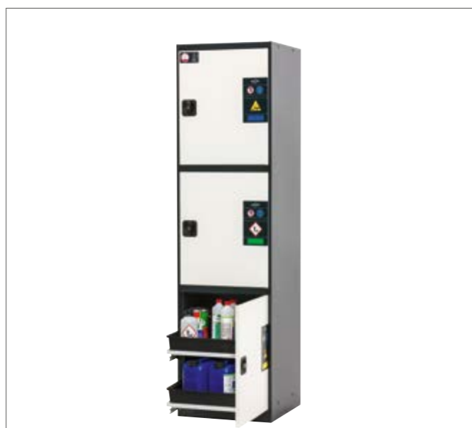
Armoire MultiRisk pour produits chimiques CS-CLASSIC Modèle CS.195.054.MH.3WD avec portes battantes, (blanc pur RAL 9010) 1 compartiment contient 1 étagère en acier revêtue d'époxy avec 1 bac de rétention au sol zingué et 1 caillebotis zingué 2 compartiments de bas contiennent chacun 2 étagères coulissantes avec un bac PE Code article 30804-050-30812
