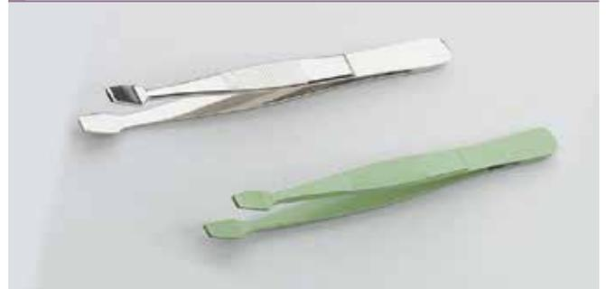
Pinza de acero inoxidable 18/8 o de acero recubierto de Teflon para cubreobjetos.
