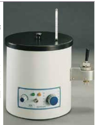
Para temperaturas ajustables de  $+5^\circ\text{C}$  a  $100^\circ\text{C}$ . Estabilidad  $\pm 1,5^\circ\text{C}$ . Panel de control :
